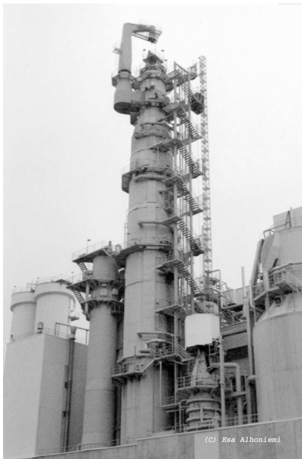
Kuva 2.1: Wisaforestin jatkuvatoimisen keittämön laitteita. Keskellä on noin 62 m:n korkuinen vuokeitin. Sen vasemmalla puolella on imeytystorni ja oikealla painediffusööripesuri. Kuvan oikeassa reunassa näkyy osa säteispesurista.
