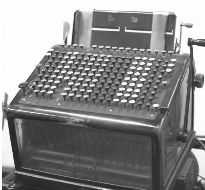
Kuva 1.2: Burroughsin laskukone toimi sekä sähkön että kierrettävän kammen avulla
